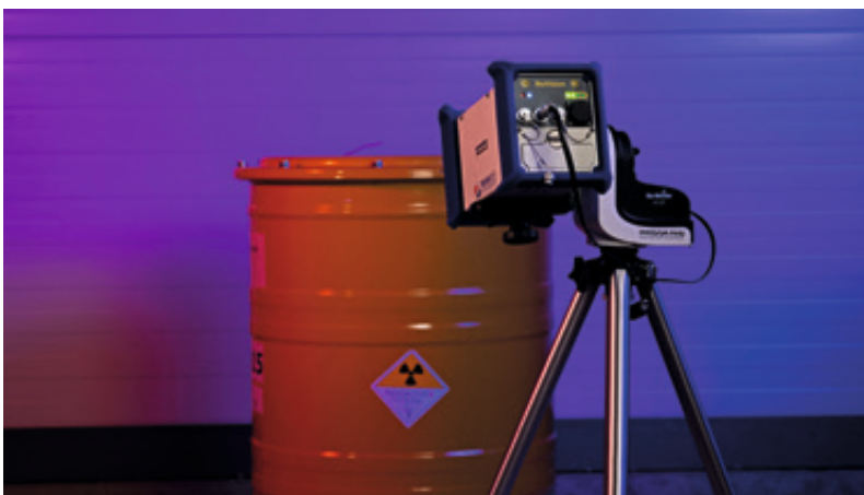
Abb. 3: Eine motorisierte Halterung erlaubt die vollständige Fernsteuerung von Gamma-Kameras – inklusive Neuausrichtung der Orientierung.
