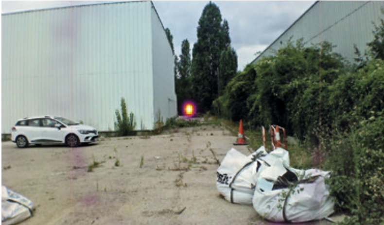
Abb. 2: Lokalisierung einer über 80 m entfernten Quelle mit TBq Aktivität Die Reduktion der Dosisleistung bei der Lokalisierung ist enorm: wenige \mu\text{Sv/h} am Ort der Kamera und mehrere \text{mSv/h} im Nahbereich der Quelle bei Messungen mit Handdetektoren
