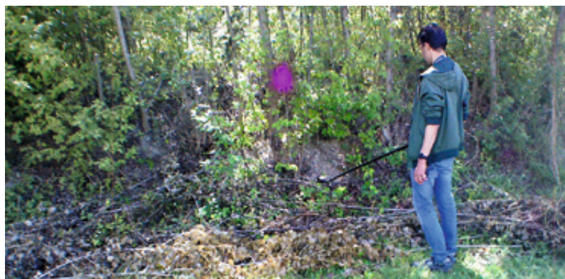
Abb. 1: Während der Strahlenschützer die Quelle mit Detektor und Teleskop noch sucht, hat die Gamma-Kamera diese bereits lokalisiert. Anhand der Farbkodierung ist das identifizierte Nuklid erkennbar.
