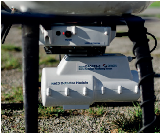
▲ BASISMODUL PLUS ZUSATZDETEKTOR FÜR DIE NUKLIDIDENTIFIZIERUNG
