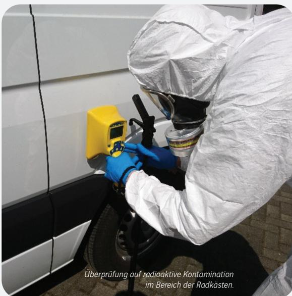
Überprüfung auf radioaktive Kontamination im Bereich der Radkästen.
