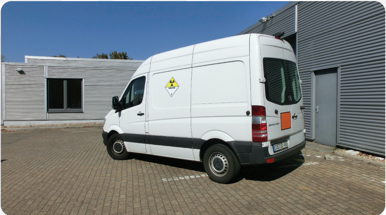
Fahrzeugbeschilderung mit oranger Warntafel und Hinweisschild Klasse 7 Transport
