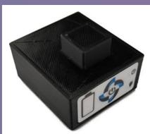
NuSafer-Sensoren, die als Netzwerk über ein Stadion verteilt werden, liefern eine Echtzeitkarte des Geländes und erkennen das Vorhandensein radioaktiver Quellen in Echtzeit. Diese bahnbrechende Technologie vermeidet arbeitsintensive und manuelle Kontrollen des Bereichs.
