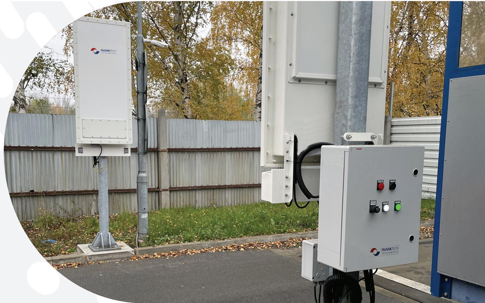
Le système de portique est équipé de deux détecteurs à scintillation de 25 litres. Le système permet d'effectuer un contrôle rapide et facile des camions et des voitures chargés de ferraille ou de déchets. L'efficacité de détection élevée garantit une grande fiabilité de détection de la radioactivité.
