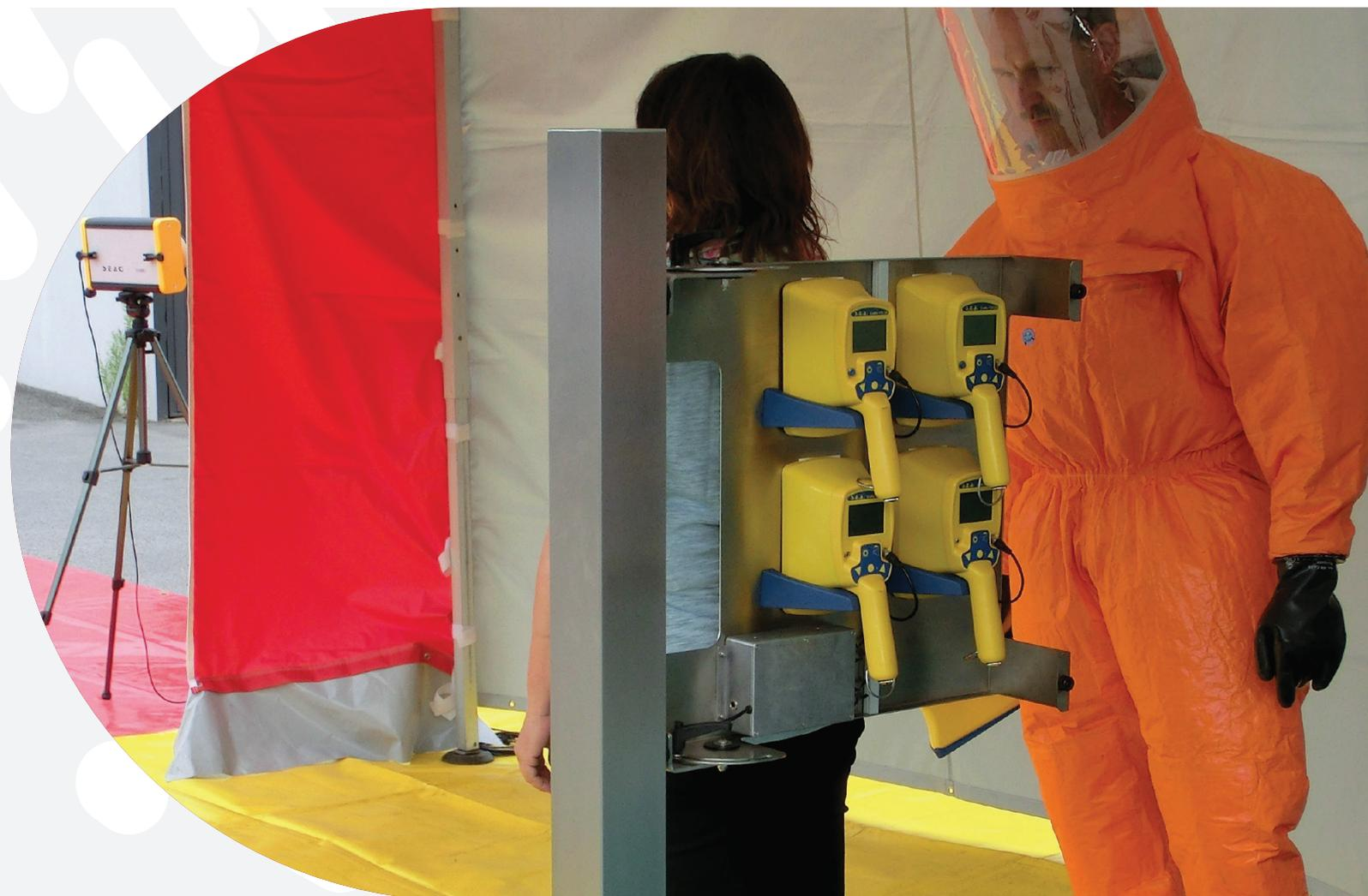
Der ECMo nutzt die beim Bevölkerungsschutz oder bei den Feuerwehren bereits vorhandenen CoMo-170-Systeme und integriert diese in eine Mechanik, verbunden mit einem PC-gestützten Messsystem. Damit ist eine einfache und stressreduzierte Kontaminationskontrolle möglich. Vom CBRN-Personal sind nur 1-2 Personen erforderlich, um bis zu 100-150 Personen pro Stunde kontrollieren zu können.
