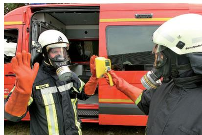
Nach dem Einsatz: Kontrolle auf radioaktive Kontamination mit einem CoMo-170 ZS.
