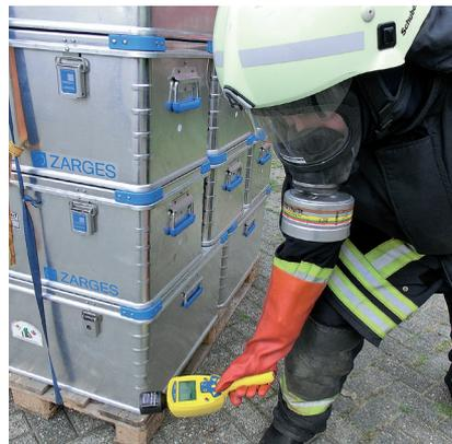
**Übungsszenario III:** Nach einem Verkehrsunfall wird mit einem SCINTO-Dosisleistungsmessgerät eine Abweichung vom Nulleffekt (ca. 50 nSv/h in Dülmen, NRW) schnell und sicher detektiert. Der SCINTO mit NaI-Detektor ist bis zu 1.000-mal empfindlicher als ein herkömmliches Messgerät mit Geiger-Müller-Zählrohr, welches bei den Feuerwehren sonst genutzt wird.
