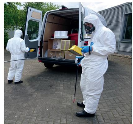
*Übungsszenario III: Nach einem Verkehrsunfall wird mit einem SCINTO-Dosisleistungsmessgerät (I.) eine Abweichung vom Nulleffekt schnell und sicher detektiert. Der SCINTO mit NaI-Detektor ist bis zu 1.000-mal empfindlicher als ein herkömmliches Messgerät mit Geiger-Müller-Zählrohr, welches bei den Feuerwehren sonst genutzt wird.*
