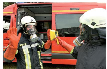
*Nach dem Einsatz: Kontrolle auf radioaktive Kontamination mit einem CoMo-170 ZS.*
