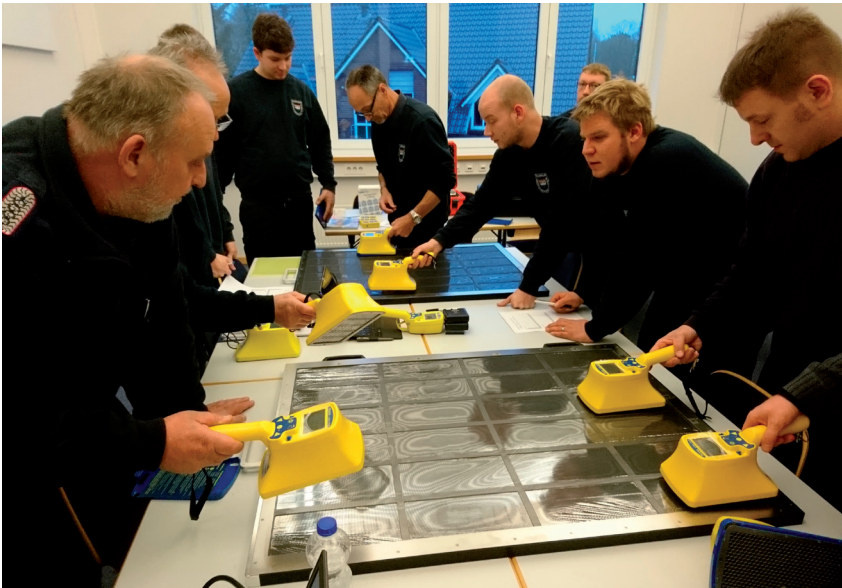
Schulungsteilnehmer suchen radioaktive Kontaminationen mit dem mobilen Kontaminationsnachweisgerät CoMo-170
