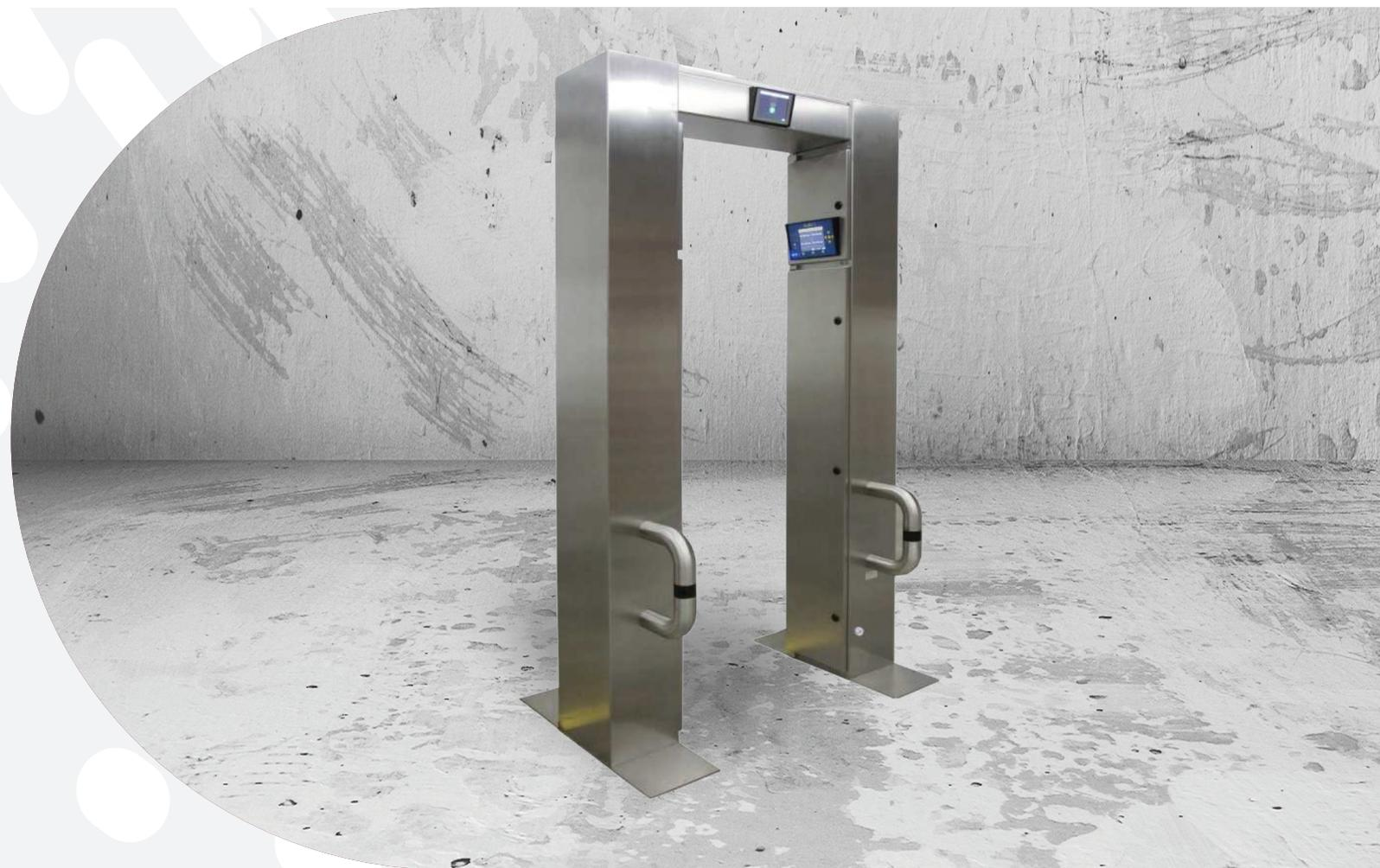
Die Arbeit mit radioaktiven Stoffen birgt die Gefahr einer Kontamination. Eine Durchgangskontrolle auf Radioaktivität erhöht daher den Schutz von Mensch und Umwelt. Großflächige Plastikszintillationsdetektoren in den seitlichen Säulen des Portal-S erkennen ionisierende Strahlung. Lichtschranken und eine automatische Messauswertung garantieren eine einfache und schnelle Überprüfung. Einstellbare Warnschwellen und Anzeigeoptionen ermöglichen individuelle Konfigurationen nach Ihren Anforderungen.
