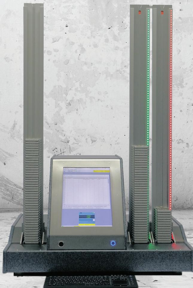
Vielfältige Kontroll- und Freimessungen resultieren in dutzende bis hunderte Wischtestproben am Tag. Der automatisierte Ablauf des WIMP 60-100 ermöglicht es, diese große Menge an Wischtestproben zu prüfen, ohne dass eine Person für die Bedienung zeitlich gebunden ist.
