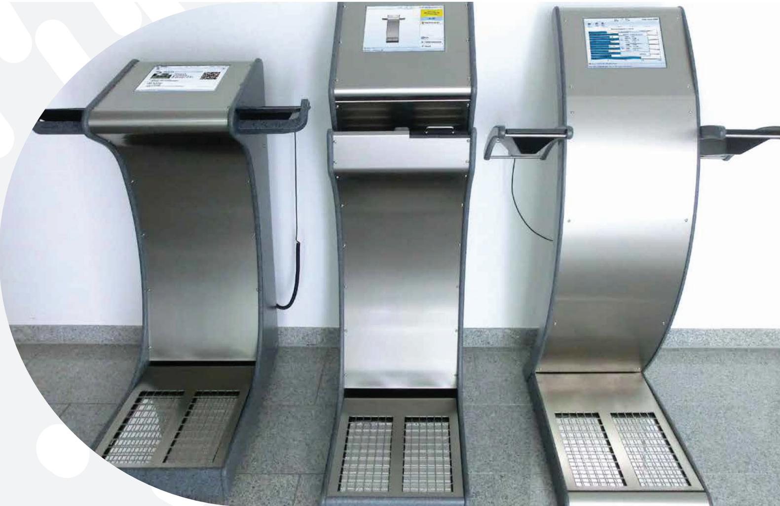
Une contamination peut se produire dès qu'on utilise une matière radioactive non-scannée. Un moniteur de contamination HFC doit être utilisé pour contrôler le personnel quittant les zones contrôlées. Les valeurs maximales de contamination de surface sont définies pour chaque nucléide. Nos moniteurs sont disponibles en plusieurs modèles et versions, toutes développées et fabriquées par NUVIA.
