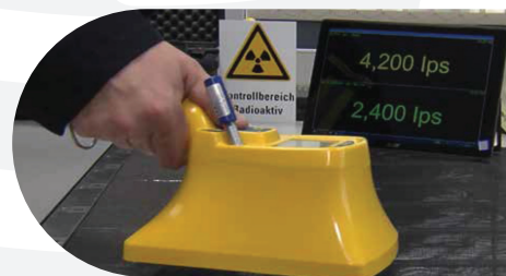
CoMo 170 DL with integrated dose rate measurement
