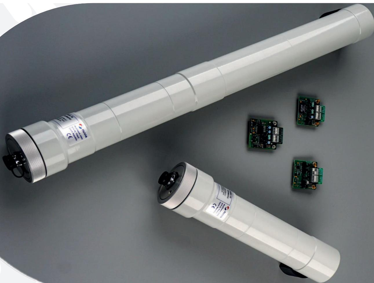
Les sondes NuDET EGM.G2 sont des sondes gamma une gamme de mesure étendue et basées sur des détecteurs GM pour une variété d'applications intérieures et extérieures autour de la mesure du débit de dose. La série EGM est conçue pour fonctionner dans des environnements de débit d'équivalent de dose ambiant allant de 10 nSv/h à 10Sv/h. Elle communique par Ethernet, USB, RS232 ou RS-485, et prend en charge les protocoles de communication MODBUS et NUVIA.
