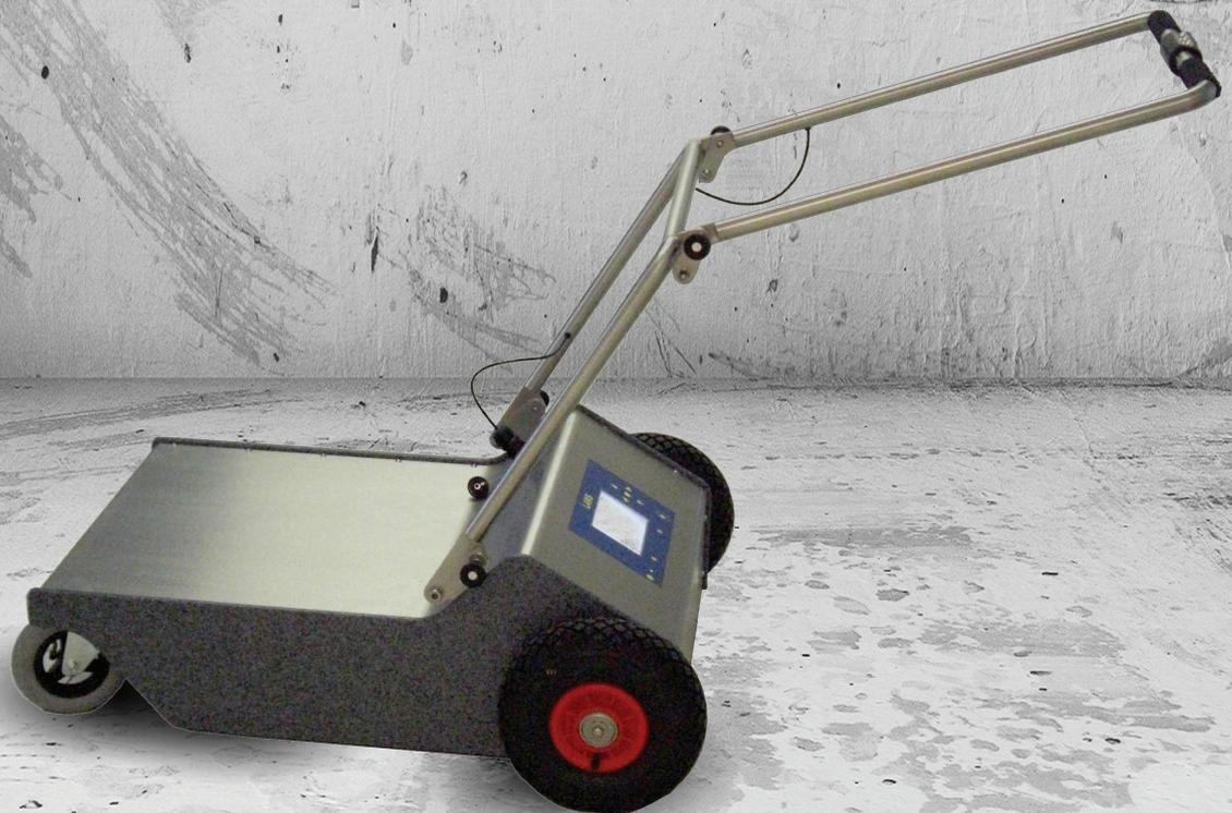
Die Kontrolle von großen Flächen auf radioaktive Kontamination benötigt eine schnelle und zuverlässige Lösung. Hierfür entwickelte NUVIATech Instruments das mobile Radioaktivitätsmesssystem LARS (Large Area Radiation Scanner). Flächen wie Straßen, Umladestationen für Brennelementbehälter oder Lagerbereiche von radioaktiven Abfällen können mit dem LARS schnell und einfach überprüft werden. Durch sein benutzerfreundliches Design kann das Messsystem vielseitig eingesetzt werden.
